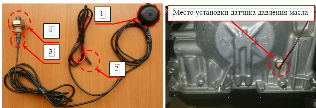
Рисунок 7 - Устройства контроля давления масла системы смазки гидромеханической трансмиссии модели 09G KGJ: 1 – индикаторная панель; 2 – «+» разъем индикаторной панели; 3 – «-» разъем индикаторной панели; 4 – датчик давления масла.
