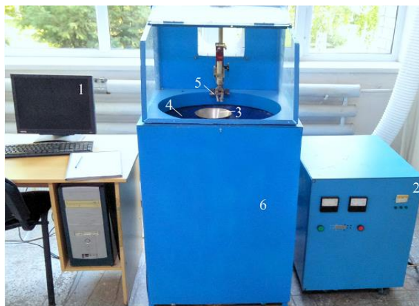
Рисунок 1 - Изображение установки для электролитно-плазменной обработки: 1– персональный компьютер; 2–источник питания; 3– сопло для электролитно-плазменной обработки (плазматрон); 4– рабочая ванна; 5– механизм зажима и установки детали или образца; 6– резервуар для электролита
