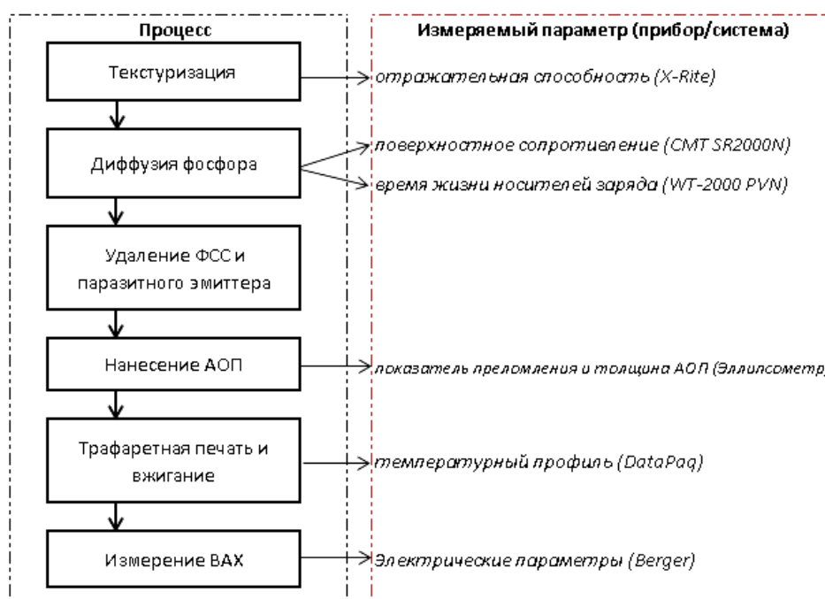
Рисунок 1 – Технологические процессы и измеряемые параметры эксперимента
