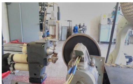
Рисунок 2– Установка МПН-004 для микроплазменного напыления порошковым материалом ролика, установленного в приспособлении
