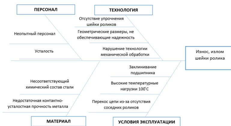
Рисунок 2 – Износ/излом шейки ролика
