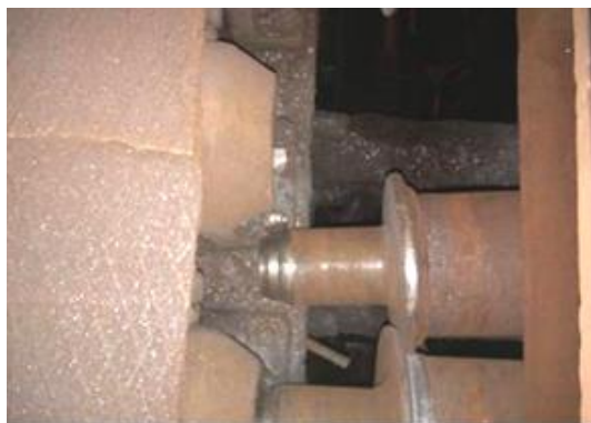
Рисунок 1 – Разрушение шейки роликов
