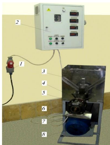
Рисунок 1 - Экспериментальная установка МПЭ-1: 1 — источник электропитания; 2 — щит управления; 3 — загрузочный бункер; 4 — орган регулировки зазора; 5 — зеерная камера; 6 — станина; 7 — сборник масла; 8 — электропривод
