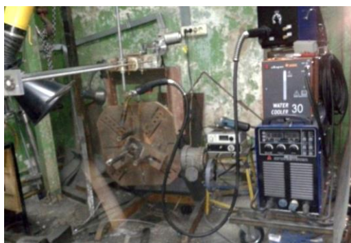
Рисунок 3 – Установка для наплавки (модель - AMI G500)
