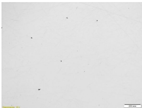
Рисунок 7 – Единичные неметаллические включения, *100
