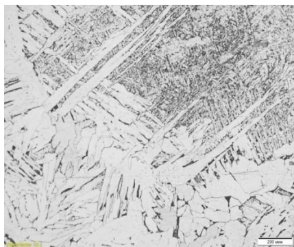
Рисунок 3 – Признаки неравномерного охлаждения, *100
