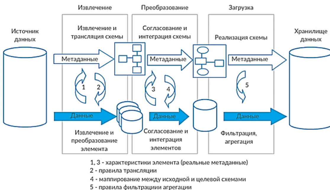
Рисунок - Схема процесса ETL
