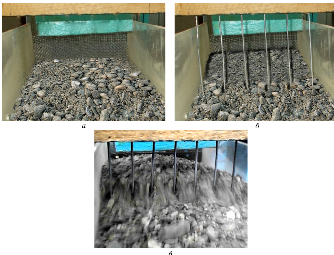
Рисунок 4 - Вид потока материала с использованием возбуждающих элементов
