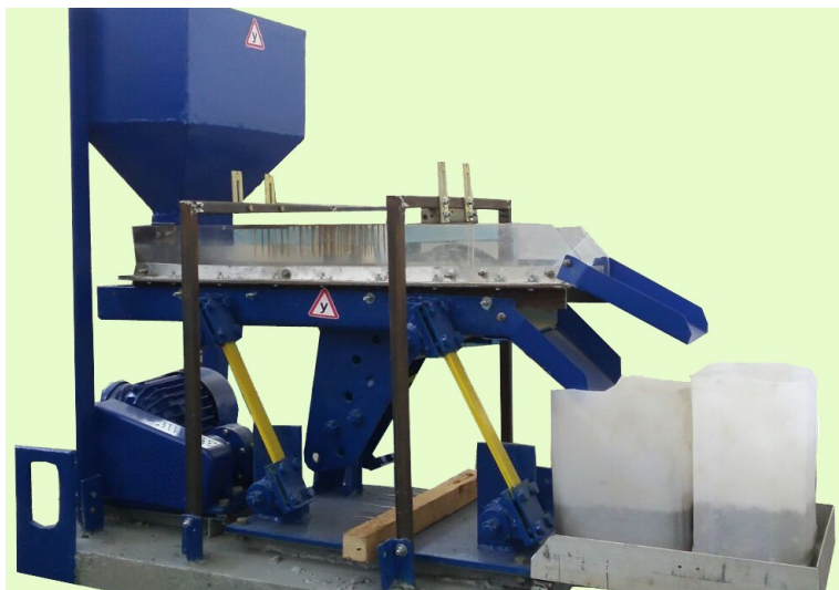
Рисунок 3 - Экспериментальная установка нового вибрационного грохота
