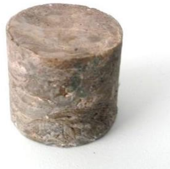
Рисунок 7 – Образец из пластиковых материалов фракцией 2х2х1 мм с пропорциями наполнителей 1:1:0,5 и с использованием металлургического шлака
