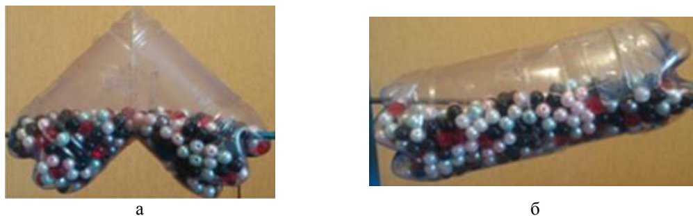
а Рисунок 9 – Стоп-кадры за полный 15-й оборот камер: а - V-образная; б - наклонная
