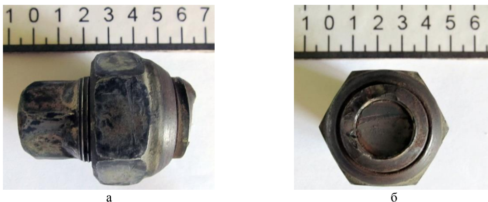
Рисунок 4 - Шпилька с футоркой и гайкой после излома: а – вид сбоку; б – вид с торца
