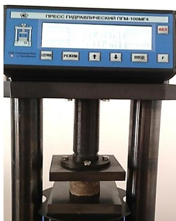
Рисунок 6 – Пресс гидравлический ПГМ 100 МГ4
