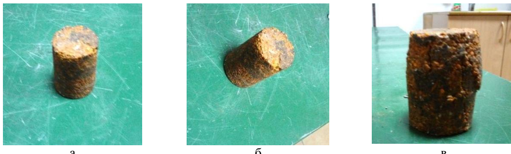
Рисунок 5 – Образцы с красителем из пластиковых материалов фракцией 2х2х1 мм: а - с пропорциями наполнителей 0,5:1,5:1; б - с пропорциями наполнителей 0,6:1,5:0,4; в - разрушение образца
