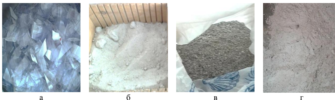
Рисунок 2 – Используемое сырье: а - нарезанный пластик (ПЭТ); б - песок речной; в - зола из экибастузского угля; г - аспирационная зола металлургического производства
