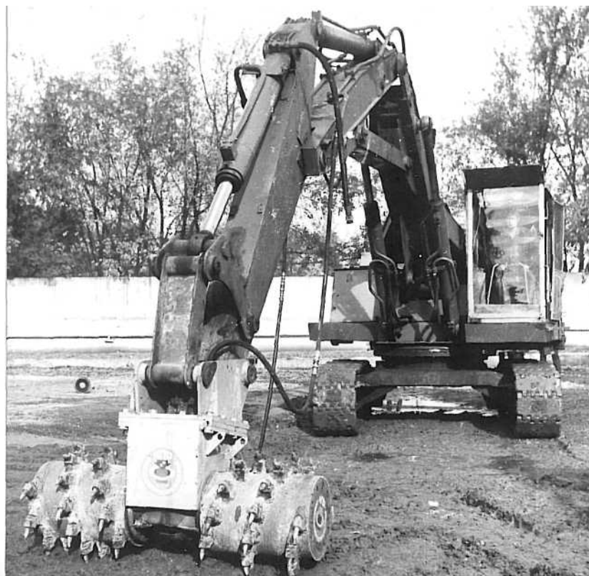
Рисунок 1 – Полноразмерная действующая модель фрезерного рыхлителя РФ-600
