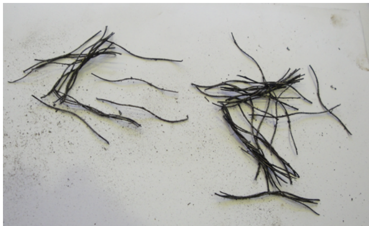
Рисунок 6 – Внешний вид полученного на РСТ продукта (черновая фибра)
