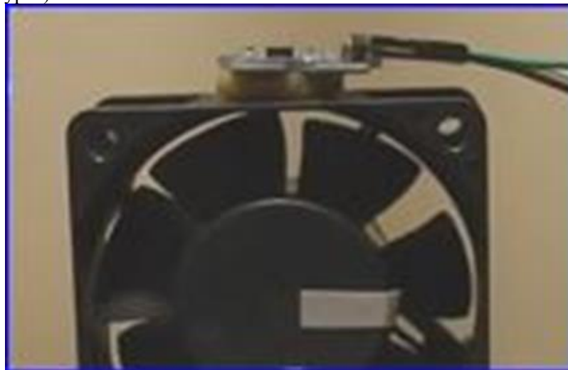
4-сурет – Қозғалтқыштан вибрация акселерометрге берілді, нәтиже 5-суретте көрсетілген: Көк сызық – бастапқы сигнал; Қызыл сызық – калман коэффициенті k=0,1 тең болғандағы деңгейлестіру; Көк сызық – калман коэффициенті k=0,1 тең болғандағы деңгейлестіру;
