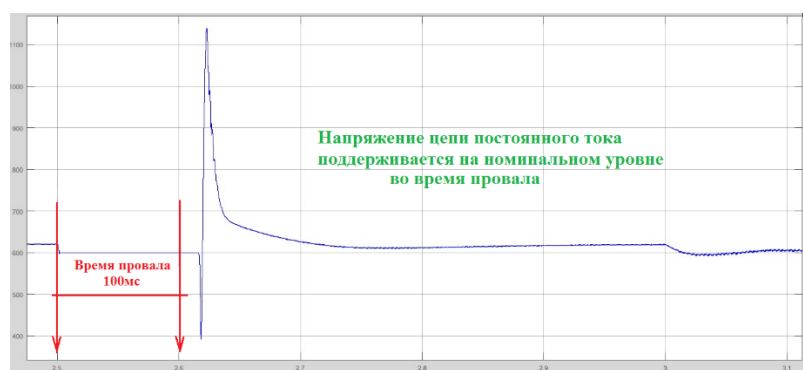
Рисунок 9 - Поддержание уровня напряжения в ЦПТ суперконденсатором
