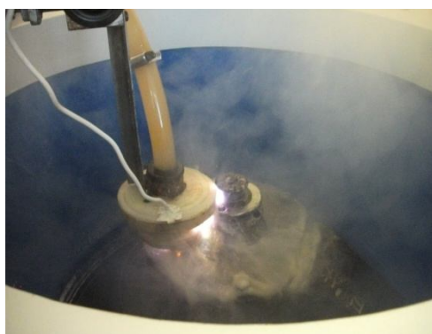
Рисунок 2 – Плазматрон в процессе ЭПО бурового долота
