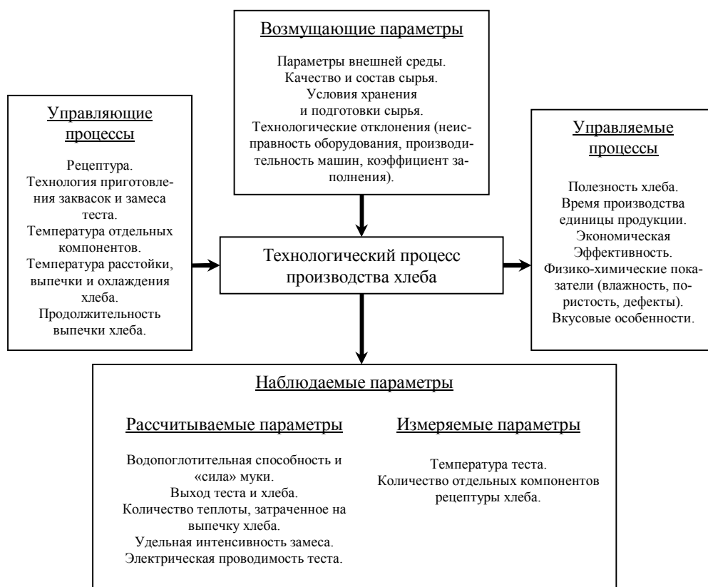
Рисунок 2 - Параметрическая схема технологического процесса производства хлеба
