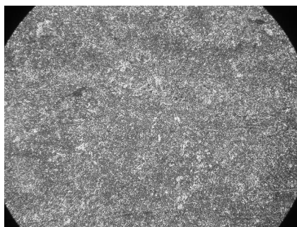
Рисунок 1 – Структура поверхности катода-изделия, обработанного электролитной плазмой с анодом – сталь 40Х
