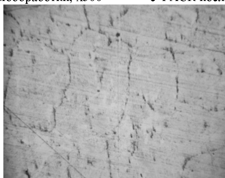
Рисунок 3 – Микроструктура стали 110Г13Л с ферробором после термообработки, \times 500
