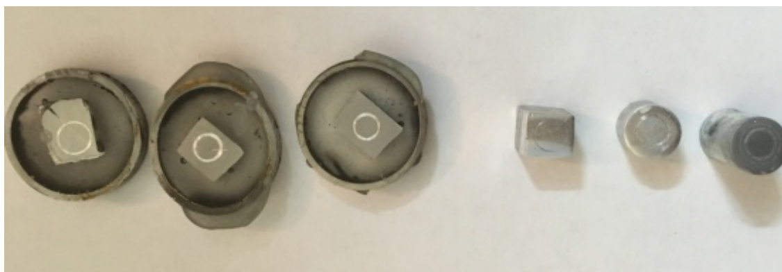
Рисунок 1- Подготовленные образцы алюминиевых сплавов АМГ6 и АМЦ для трибологических испытаний по схеме «шарик – диск»
