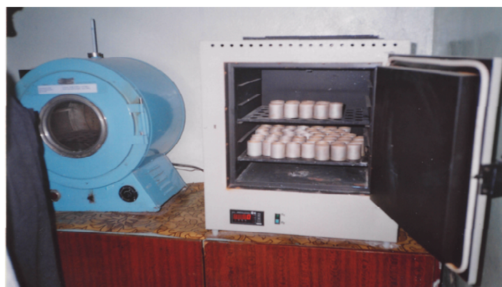
Рисунок 3 – Размещение заполненных бюксов в шкафу для сушки грунта при t = 105^{\circ}\text{C}
