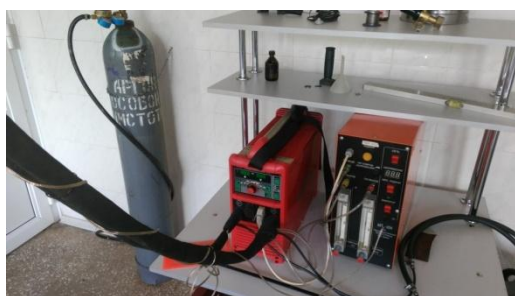
Рисунок 3 – Источник питания и газа для микроплазменного напыления
