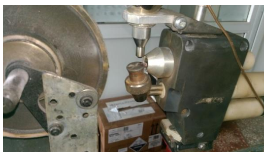
Рисунок 4 – Процесс микроплазменного напыления образцов
