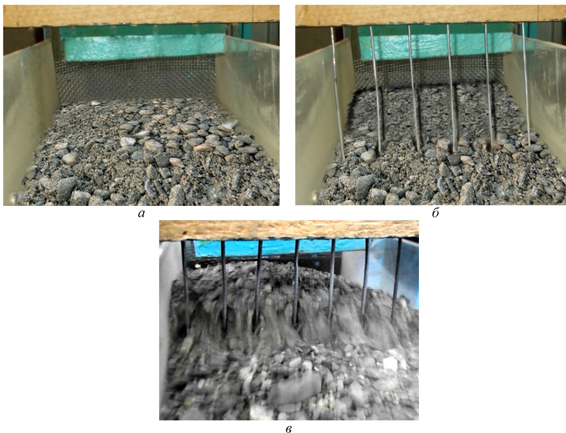
Рисунок 4 - Вид потока материала с использованием возбуждающих элементов
