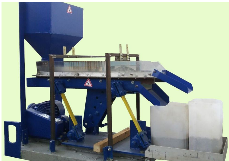
Рисунок 3 - Экспериментальная установка нового вибрационного грохота
