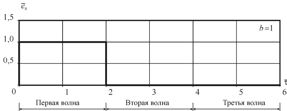
Рисунок 2 – Функция формы импульса, генерируемого пауэром с параметром \xi = 0 при b=1
