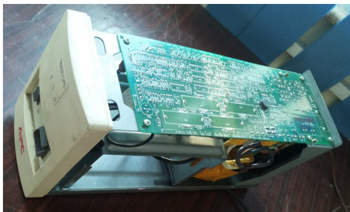
Рисунок 6 – Преобразователь постоянного тока в переменный
