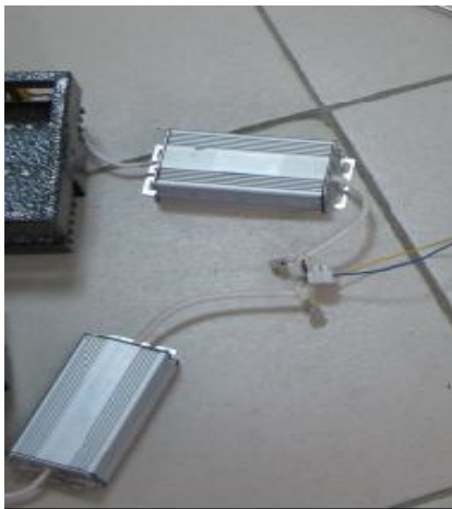
Рисунок 7 – Внешний вид преобразователя напряжения с 220 В на 24 В
