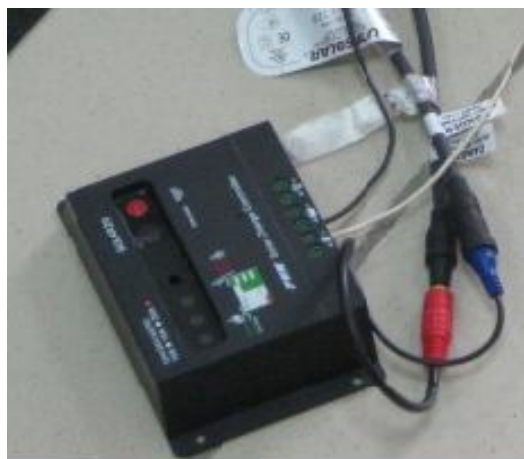
Рисунок 12 – Контроллер заряда аккумулятора
