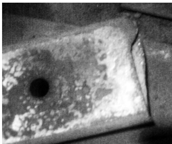
Рисунок 6 - Часть листа рессоры после излома
