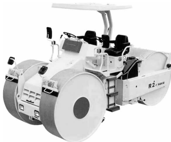
Рисунок 2 – Трехвальный 2-осный каток R-2 фирмы «Sakai» с одинаковым диаметром и распределенной массой всех вальцов
