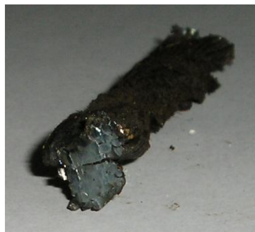
время резки – 8 с (свариваемость максимальна)
