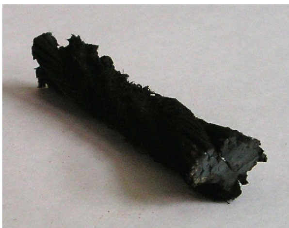
время резки – 2 с (свариваемость минимальна)
