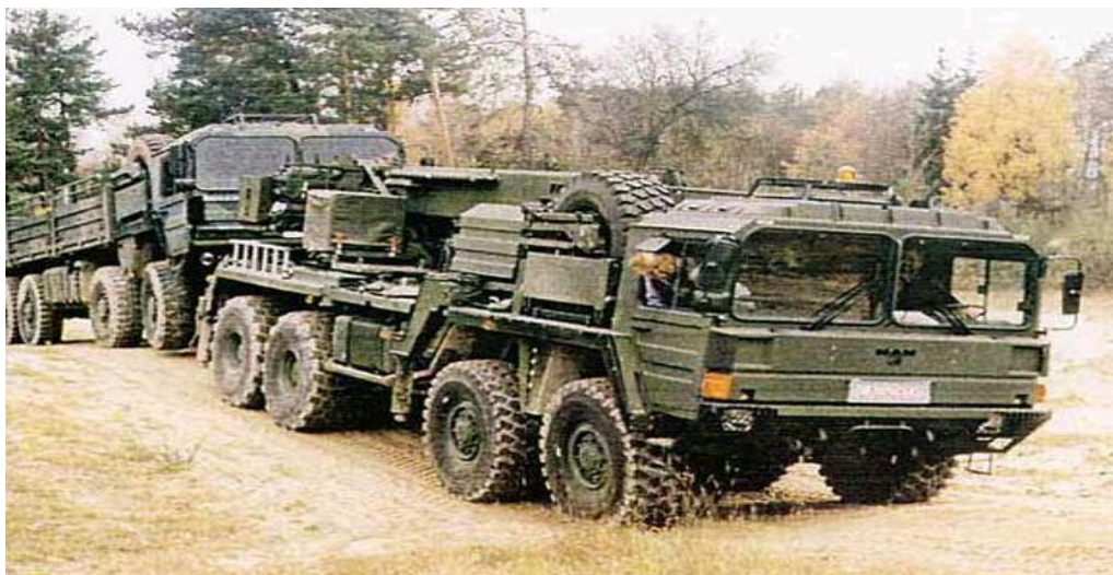
Рисунок 3 - Запуск двигателя с помощью жесткой сцепки
