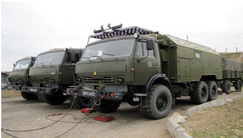
Рисунок 2 - Запуск двигателя с помощью гибкой сцепки
