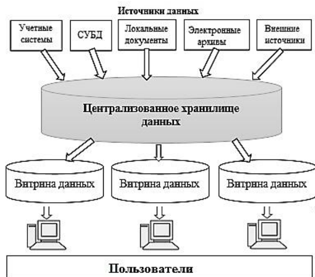
Рисунок 3 - Схема консолидации данных с помощью витрин данных
