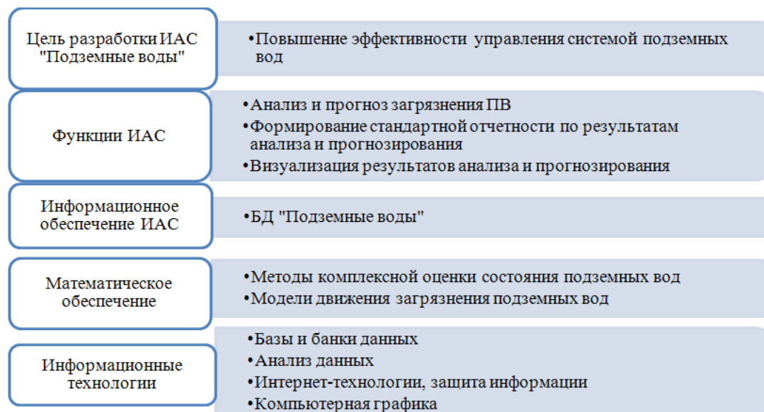
Рисунок 1 - Концепция разработки информационно-аналитической системы экологического мониторинга подземных вод
