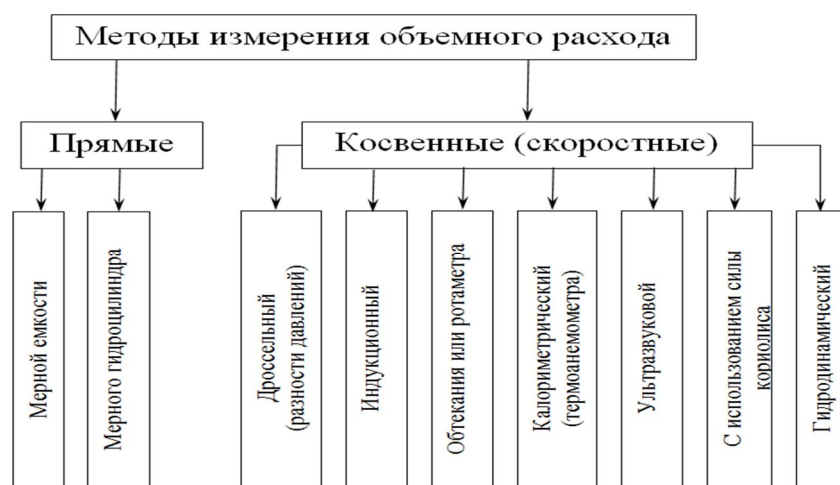
Рисунок 1 – Классификация методов измерения объемного расхода жидкостей
