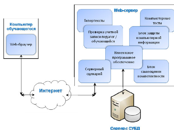
Рисунок 1 - Примерная архитектура информационной системы электронного образовательного ресурса для дистанционного обучения
