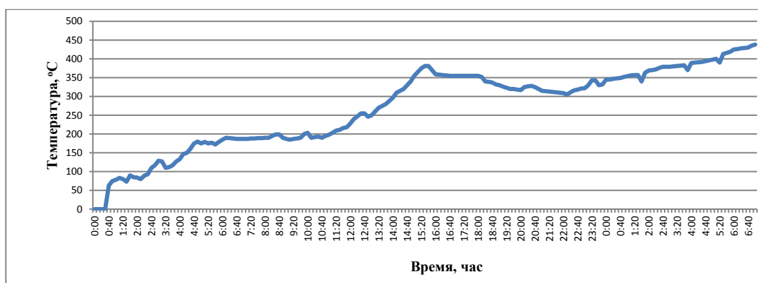
Рисунок 10 – Действительный график разогрева печи спекания после капитального ремонта
