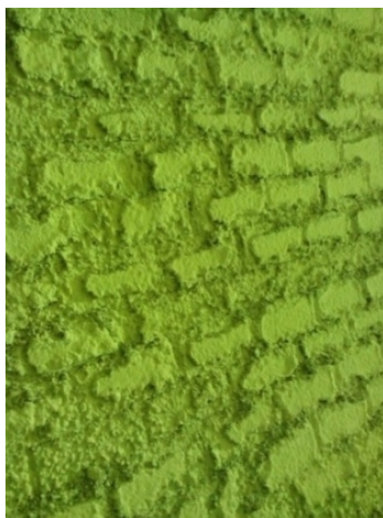
Рисунок 5 – Износ футеровки в виде чешуйчатого скалывания
