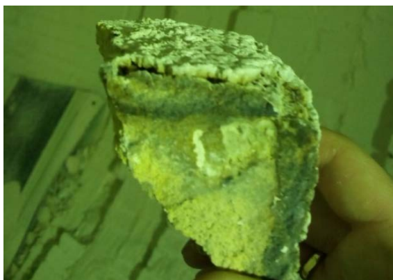
Рисунок 3 – Глубина пропитки шамотного огнеупора из зоны кальцинации
