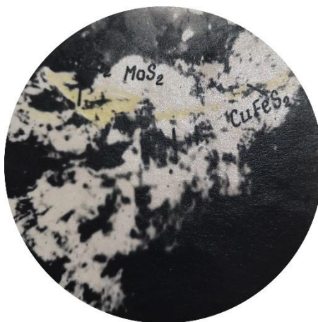
Рисунок 2 - Просечки халькопирита (желтый) в молибдените (светлый)
