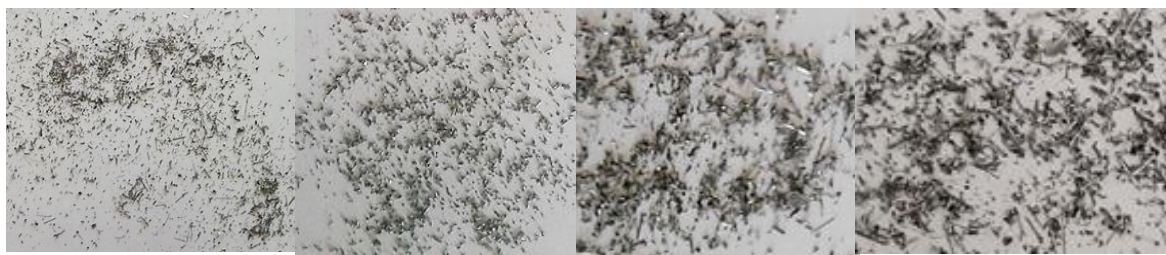
Рисунок 7 - Стружки, полученные при различных режимах резания: а - n_{\text{шп}} = 1000 об/мин, S_{\text{ст}} = 20 мм/мин, t = 1 мм; б - n_{\text{шп}} = 1500 об/мин, S_{\text{ст}} = 40 мм/мин, t = 1 мм; в - n_{\text{шп}} = 2000 об/мин, S_{\text{ст}} = 60 мм/мин, t = 1 мм; г - n_{\text{шп}} = 2500 об/мин, S_{\text{ст}} = 60 мм/мин, t = 1 мм
