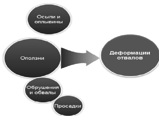
Рисунок 2 – Основные виды деформаций насыпных искусственных сооружений
