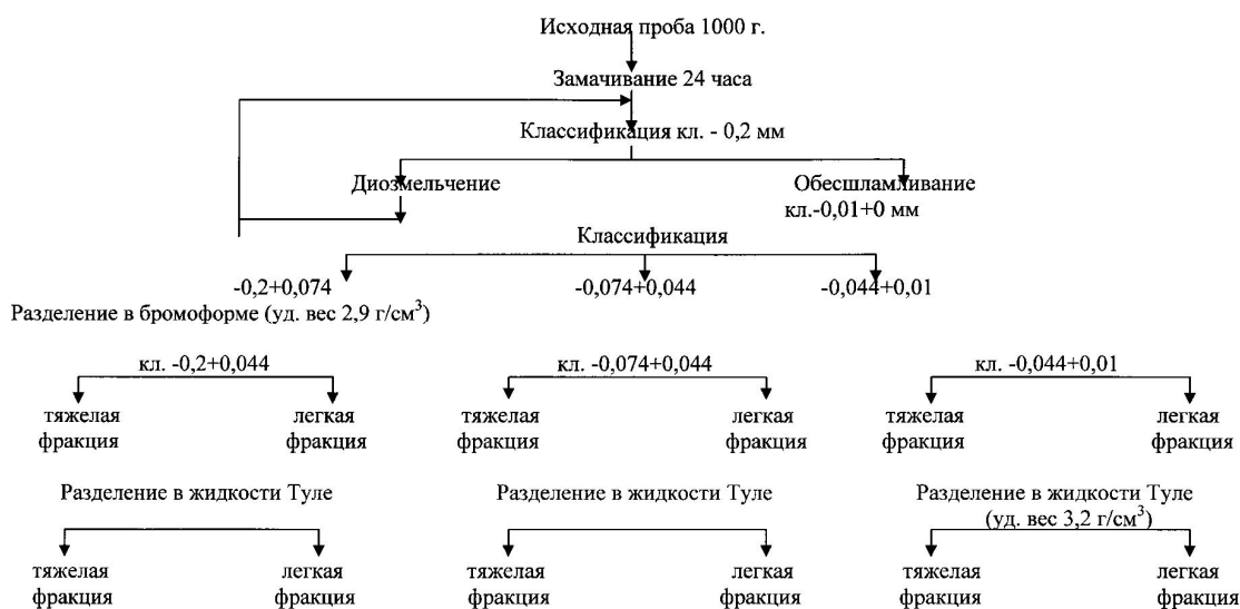
Рисунок 1 – Схема гравитационного анализа средней пробы кека выщелачивания
