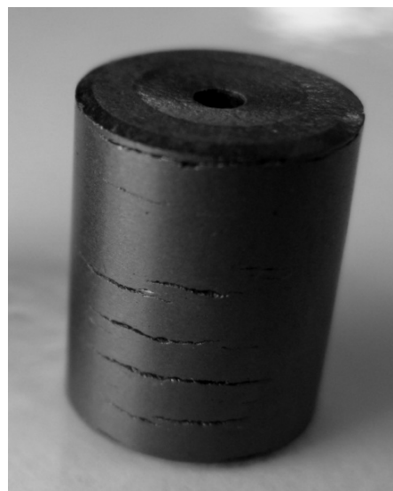
Рисунок 2 – Поверхностные трещины на прессовке после выталкивания
