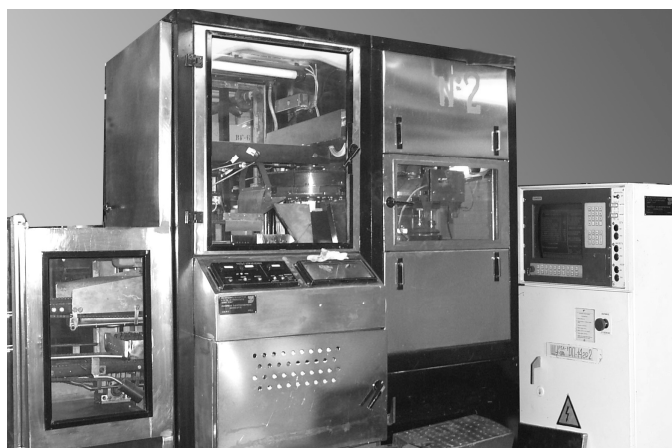
Рисунок 2 – Роторная линия для прессования таблеток ядерного горючего
