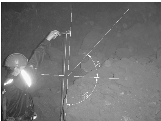
Рисунок 3 - Фотография откоса навала отбитой руды в камере № 30 Родниковой рудной зоны в этаже 13 гор.+25 м
