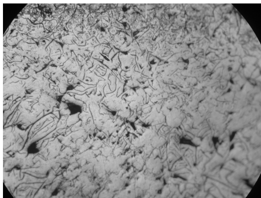
Рисунок 5 - Микроструктура поверхности (видны отпечатки алмазной пирамиды) \times 500
