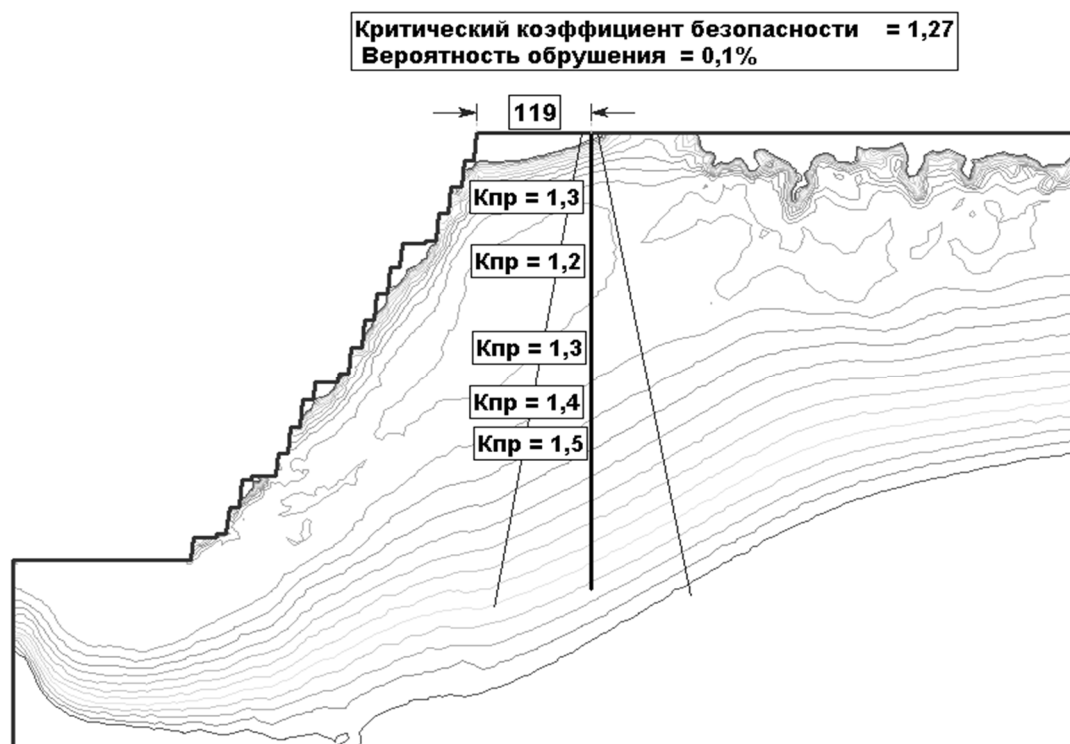
Рисунок 2 - Результаты расчета устойчивости системы «борт карьера - ствол шт. «Капитальная» методом конечных элементов (угол откоса уступа - 84 град., угол откоса борта карьера - 58 град., ширина предохранительной бермы - 10 м)
