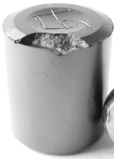
Рисунок 1 – Торцевой скол на торце спрессованной на роторной линии «РТЛ» таблетки из порошка диоксида урана со стороны выталкивающего пуансона
