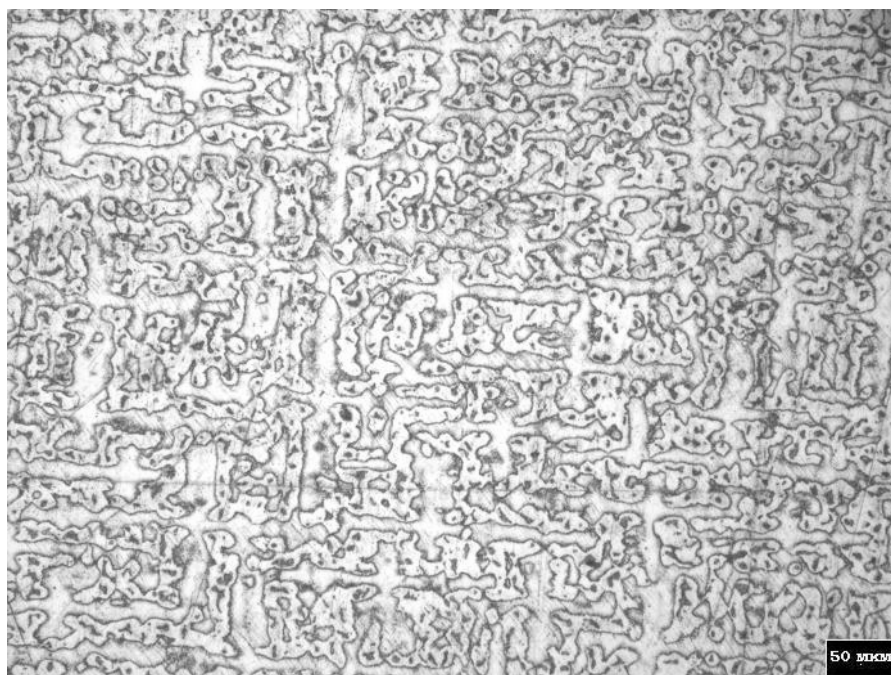
Рис. 3. Ячеисто-дендритная субструктура зерен слитка сплава СрМ 925 после травления в смеси аммиачной воды и перекиси водорода, \times 170
