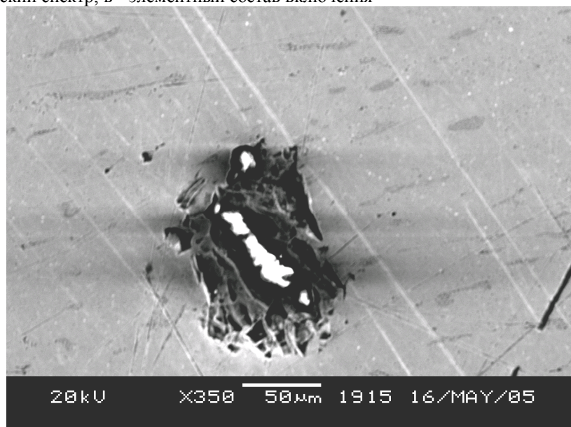
Рис. 6. Электронный снимок включения на основе оксида железа: а - во вторичных электронах, б - рентгеновский спектр, в - элементный состав включения
