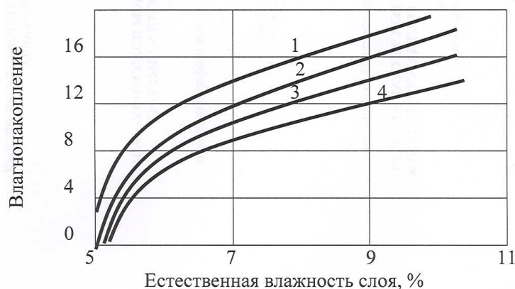
Рисунок 1 – Зависимость влагонакопления от естественной влажности грунта:
