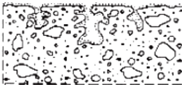
Рисунок 1 - Схематическое изображение гидрофобного слоя на поверхности бетона
