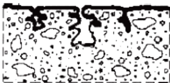
Рисунок 2 - Схематическое изображение пропитки частично колюматирующими составами
