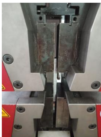
Рисунок 4 – Процесс испытания образцов на предел прочности на разрывной машине РМ 50 в соответствии с ISO 5173-81
