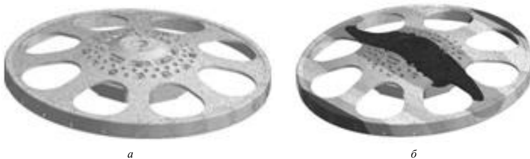
4-сурет – Соңғы-элементтік ротор динамикасын модельдеу: а – соңғы-элементтік модель; б – бірінші өз жиілігіне сәйкес келетін тербеліс модасы түріндегі модельдеу нәтижелері
