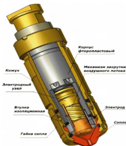
Рисунок 1 – Устройство плазмотрона
