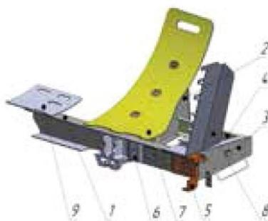
*Рисунок 5 – Модели полурам (третий вариант исполнения), крайняя полурама: 1 – хребтовая балка; 2 – шкворневая балка; 3 – концевая балка; 4 – боковая балка; 5 – упор передний; 6 – упор задний; 7 – опорный лист котла; 8 – защитный экран; 9 – лист опорный малый*
