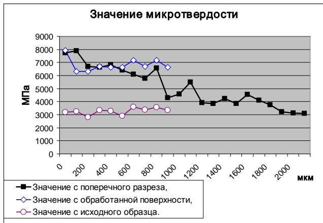
Рисунок 5 – Зависимость микротвердости от глубины поперечного разреза при плазменной резке стали 20Х
