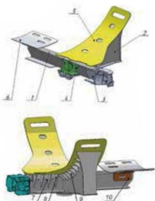
Рисунок 4 – Модели полурам (второй вариант исполнения), средняя полурама: 1 – хребтовая балка; 2 – шкворневая балка; 3 – упор беззазорного сцепного устройства; 4 – надпяятник; 5 – опорный лист котла; 6 – лист опорный малый; 7 – лист вертикальный опорного листа котла; 8 – ребро вертикальной опоры; 9 – ко-сынка соединения опорного листа и шкворневой балки; 10 – дополнительный подкрепляющий элемент
