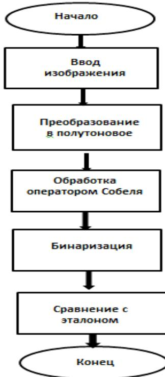
Рисунок 1 – Схема проведения контроля качества с помощью алгоритмов компьютерного зрения
