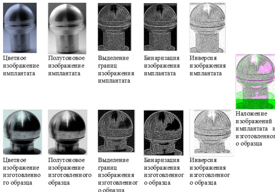
Рисунок 2 – Принцип проведения сравнения изображений на примере эндопротеза тазобедренного сустава
