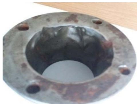
*Рисунок 2 – Износ внутренней поверхности седла дросселя*
