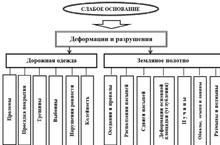
Рисунок 1 – Деформации и разрушения на конструкциях дорожных одежд, связанные с применением слабых грунтов
