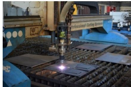
*Рисунок 1 – Плазменная резка заготовок из стали 09Г2С*
