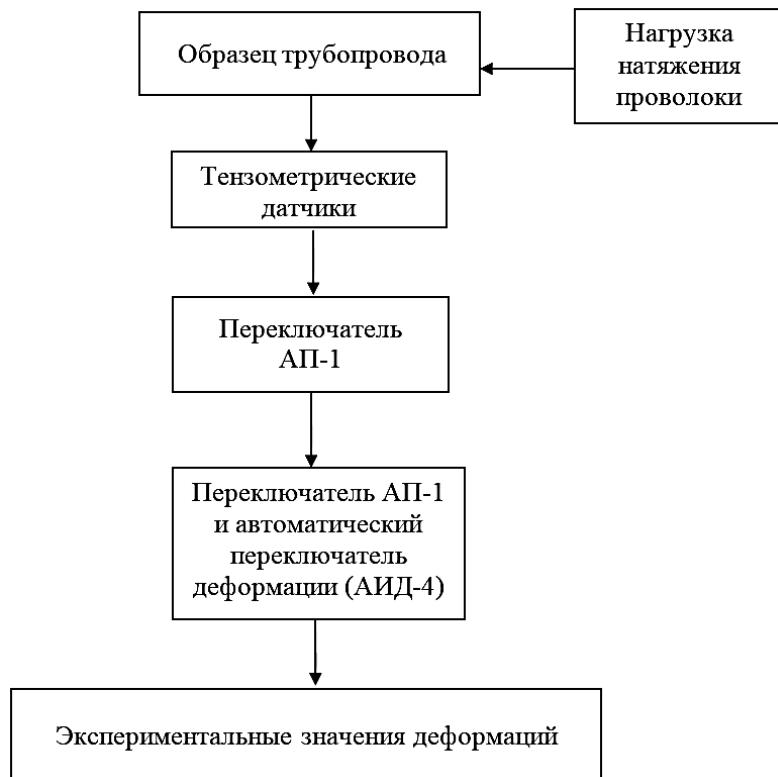
*Рисунок 1 – Иллюстрация схемы эксперимента*
