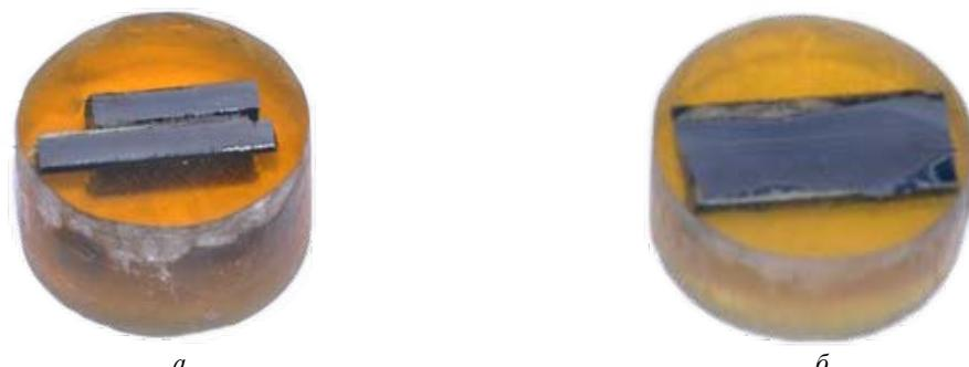
*Рисунок 3 – Микрошлифы для исследования влияния режимов резания на микроструктуру:
