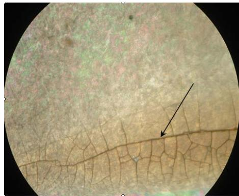
Рисунок 2 – Микроструктура стали 18ХН3МА-Ш после цементации и закалки  $\times 100$
