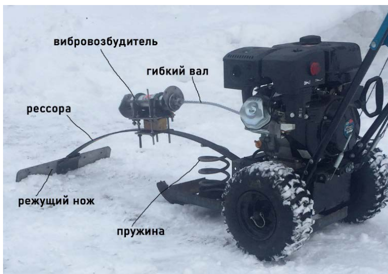
Рисунок 7 – Установка пружины под упругой рессорой и соединение вибровозбудителя гибким валом с приводным двигателем
