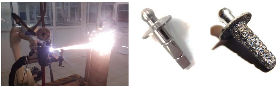
Рисунок 3 – Процесс роботизированного МПН танталовой проволоки и эндопротез локтевого сустава из титанового сплава до и после МПН
