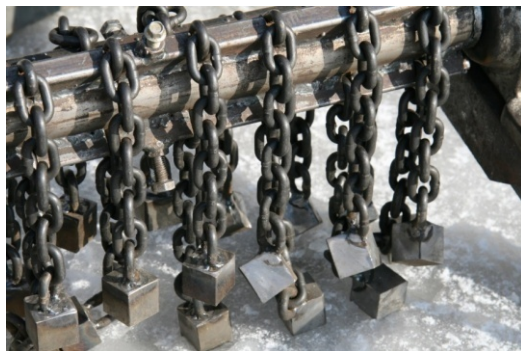
Рисунок 2 – Крепление кубических бойков посредством гибкой связи на приводном валу льдоскалывателя
