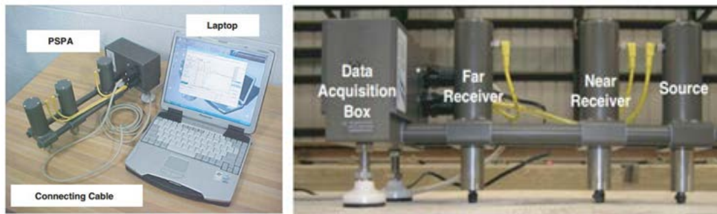
Рисунок 6 – Пример оборудования для спектрального анализа поверхностных волн: портативный сейсмический анализатор покрытия (приводится по [27])
