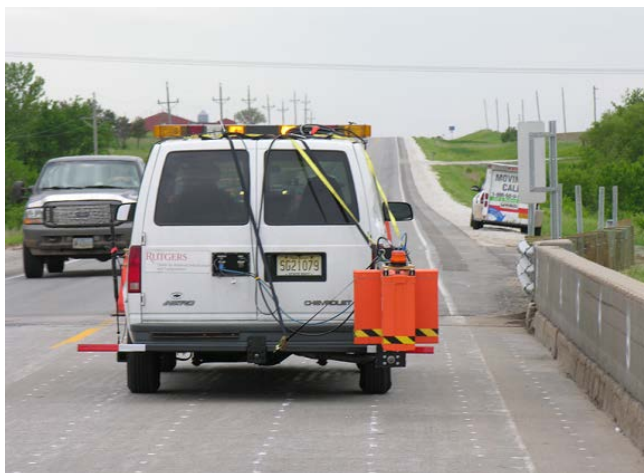
Рисунок 5 – Георадар, монтируемый на автомобиле, для скоростного измерения дорожного покрытия
