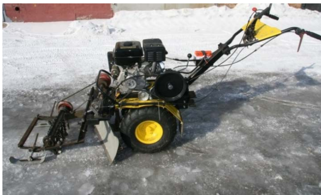
Рисунок 3 – Общий вид опытного образца самоходной льдоскалывающей машины с цепным рабочим органом
