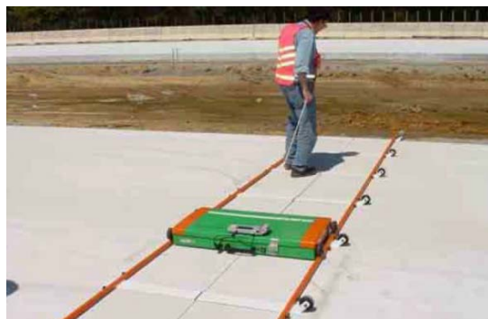
Рисунок 3 – MIT Scan-2: магнитно-импульсное индукционное устройство и его применение на бетонном покрытии
