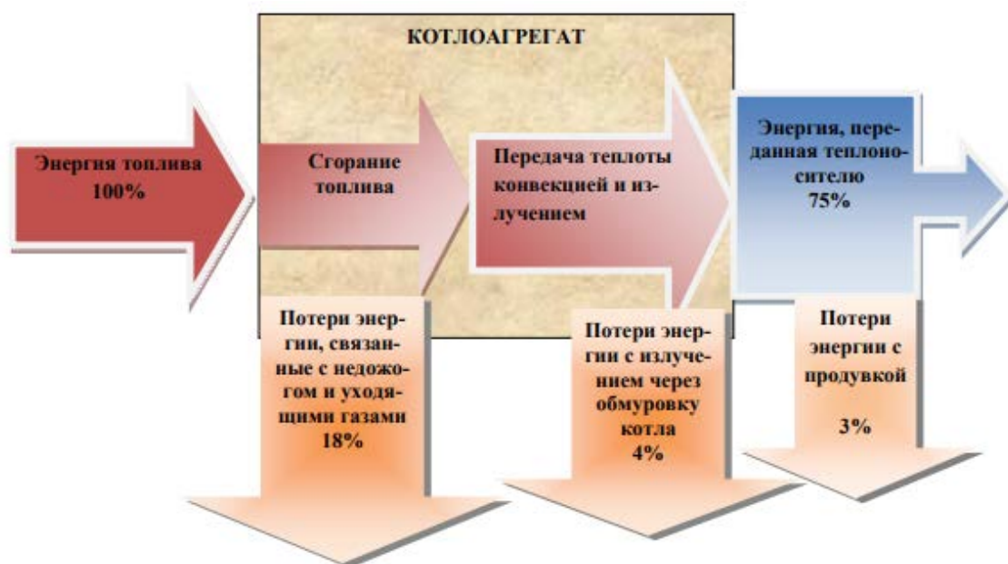
Рисунок 1 – Энергетический анализ потерь энергии в котлоагрегате КЕ-25-14
