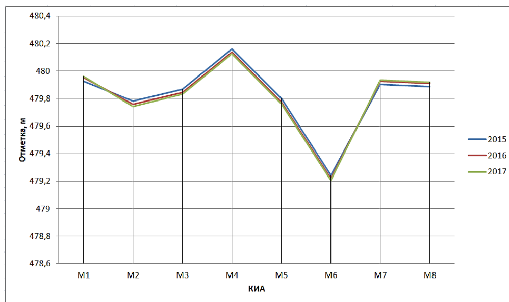
Рисунок 3 – Результаты изменения высотных отметок наблюдаемых марок хвостохранилища за период 2015-2017 гг.
