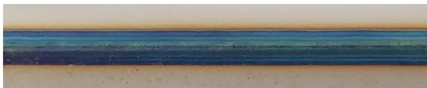
Рисунок 3.18 – Пример изображения сварного соединения с сильным окислением металла
