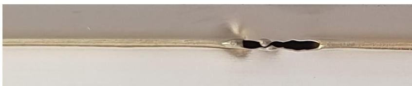
Рисунок 3.10 – Исследуемое изображение сварного соединения с прожогом
