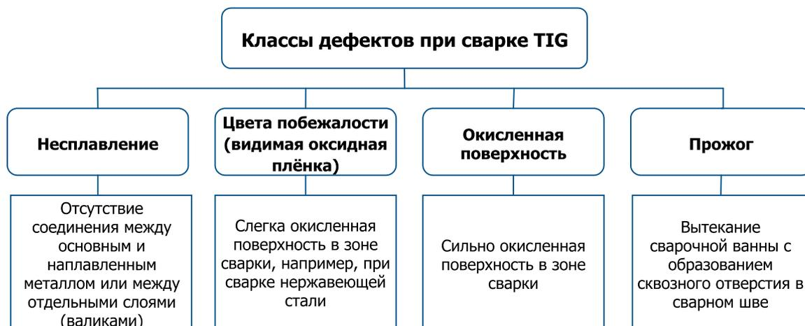
Рисунок 1.3 – Основные классы дефектов при сварке TIG
