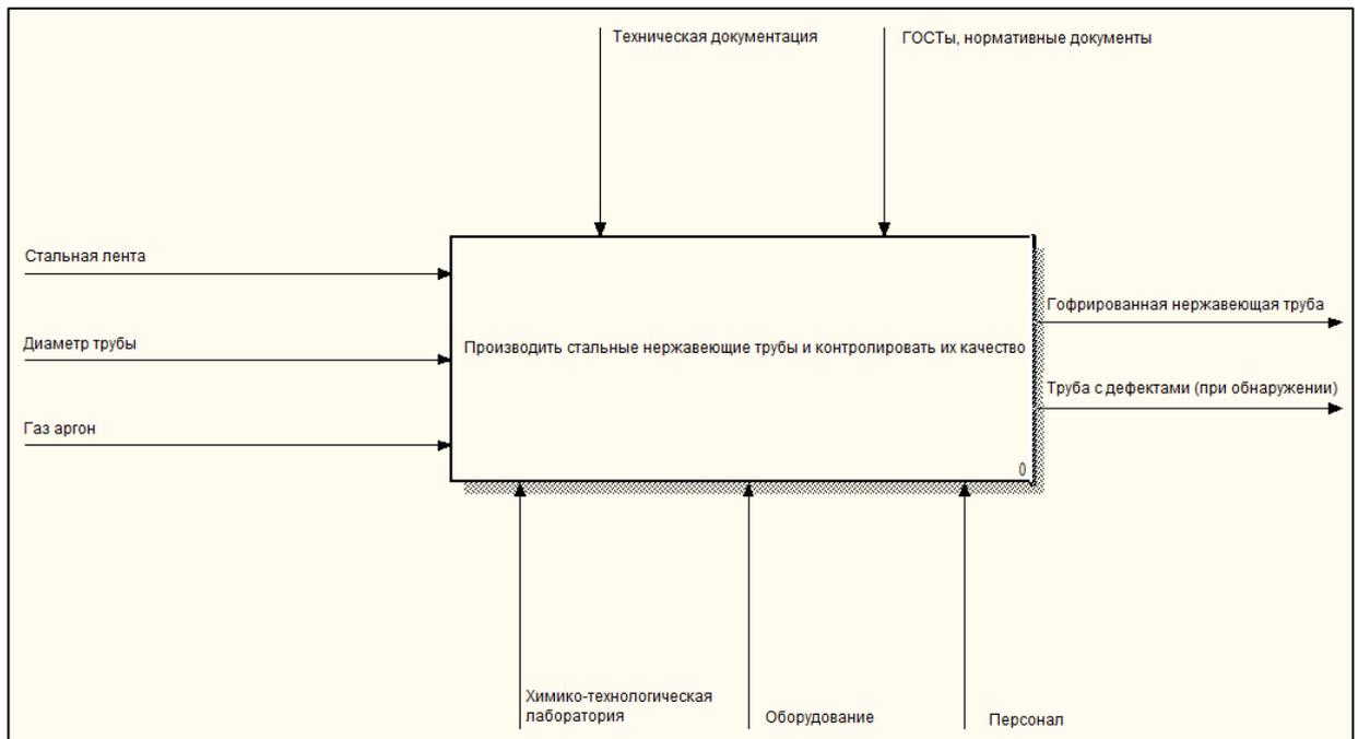
Рисунок 1.1 – Функциональная модель верхнего уровня производства и контроля качества гибких гофрированных труб из нержавеющей стали
