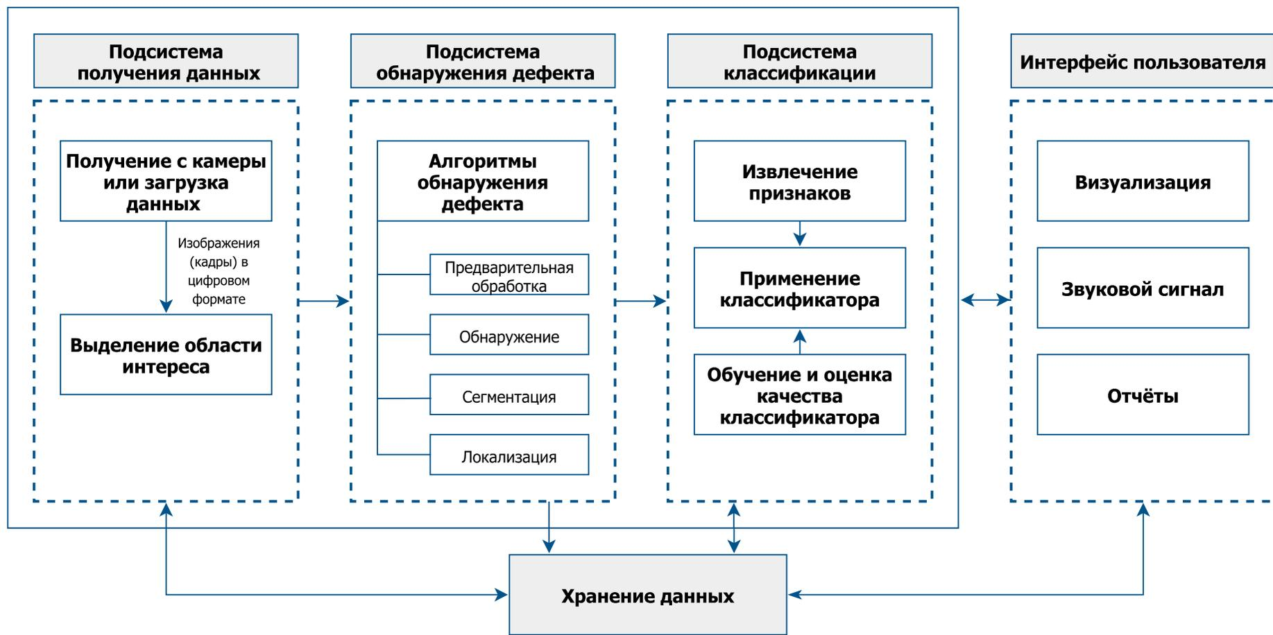
Рисунок 3.1 – Структурная схема программной системы для обнаружения и распознавания дефектов сварных соединений
