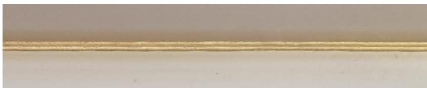
Рисунок 3.16 – Пример изображения сварного соединения без дефекта
