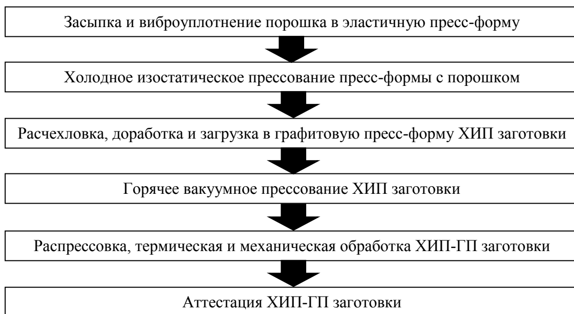
Рисунок 3.6 – Технологическая схема процесса горячего вакуумного прессования
