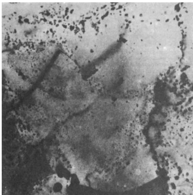
Рисунок 1.9 – Дисперсные частицы BeO в бериллии (просвечивающая электронная микроскопия, \times 100000 )
