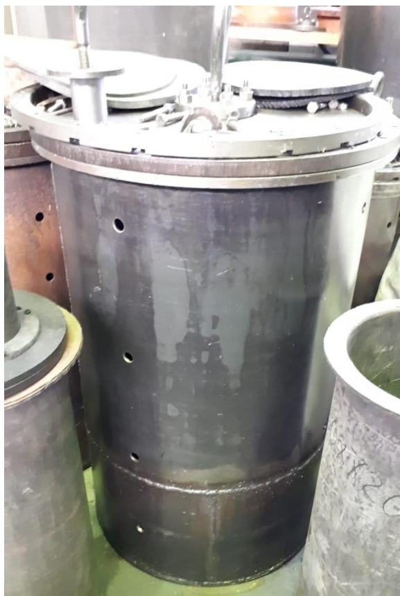
Рисунок 5.2 – Эластичная пресс форма в стальном перфорированном каркасе для ХИП
