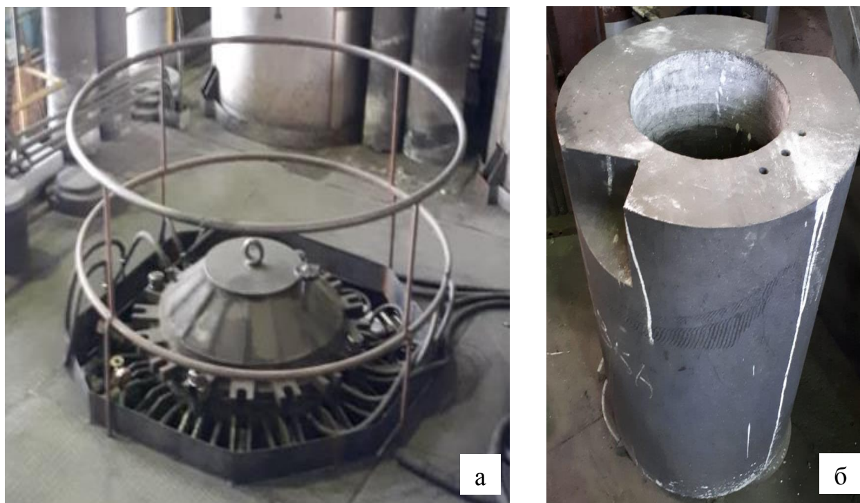
Рисунок 3.8 – Печь (пресс) горячего прессования ГПВ-200. Крышка загрузочного отверстия печи (а). Графитовая пресс-форма (б)
