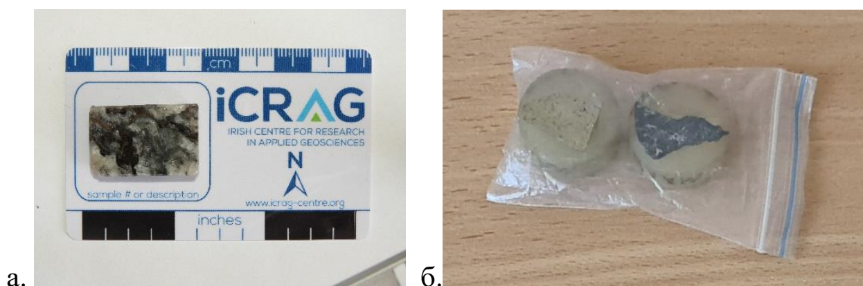
Рисунок 3.6 - Образцы для минералогических исследований: а – аншлифы; б – плашки минерализованных кварцитов и прожилково-вкрапленной руды (пирит)
