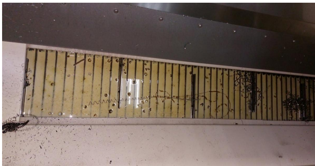
Рисунок 1.2 - Канал для отвода СОЖ в станке DMG MORI CTX 510 ecoline
