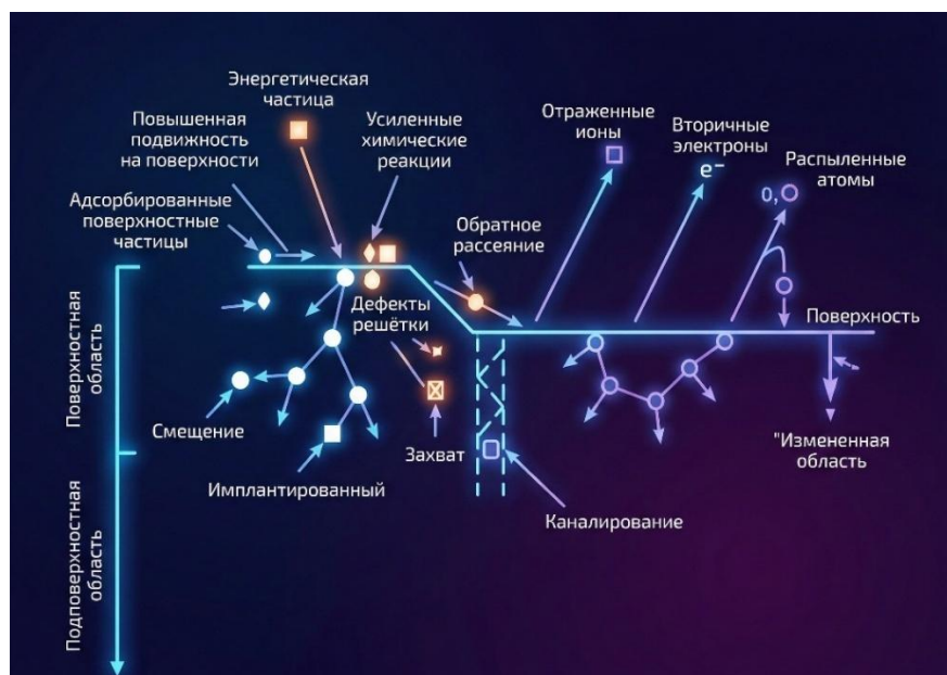
Рисунок 2.7 - Схема физических процессов на поверхности мишени при ионной бомбардировке. Различная масса атомов Ta и Cu приводит к разной эффективности распыления, что требует отдельной регулировки мощности магнетронов
