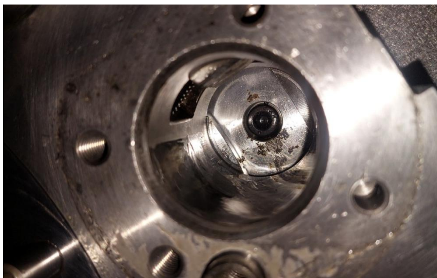
Рисунок 1.1 - Деградация прецизионных поверхностей шпиндельного узла станка с ЧПУ
