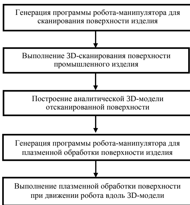
Рисунок 2.11 –Блок- схема процесса роботизированной плазменной обработки поверхности с использованием предварительного 3D сканирования
