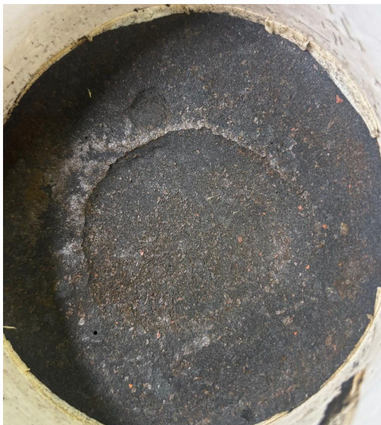
Рисунок 3.11 – Красные включения куприта \text{Cu}_2\text{O} в кеке, образовавшиеся при превышении верхней границы рабочего pH
