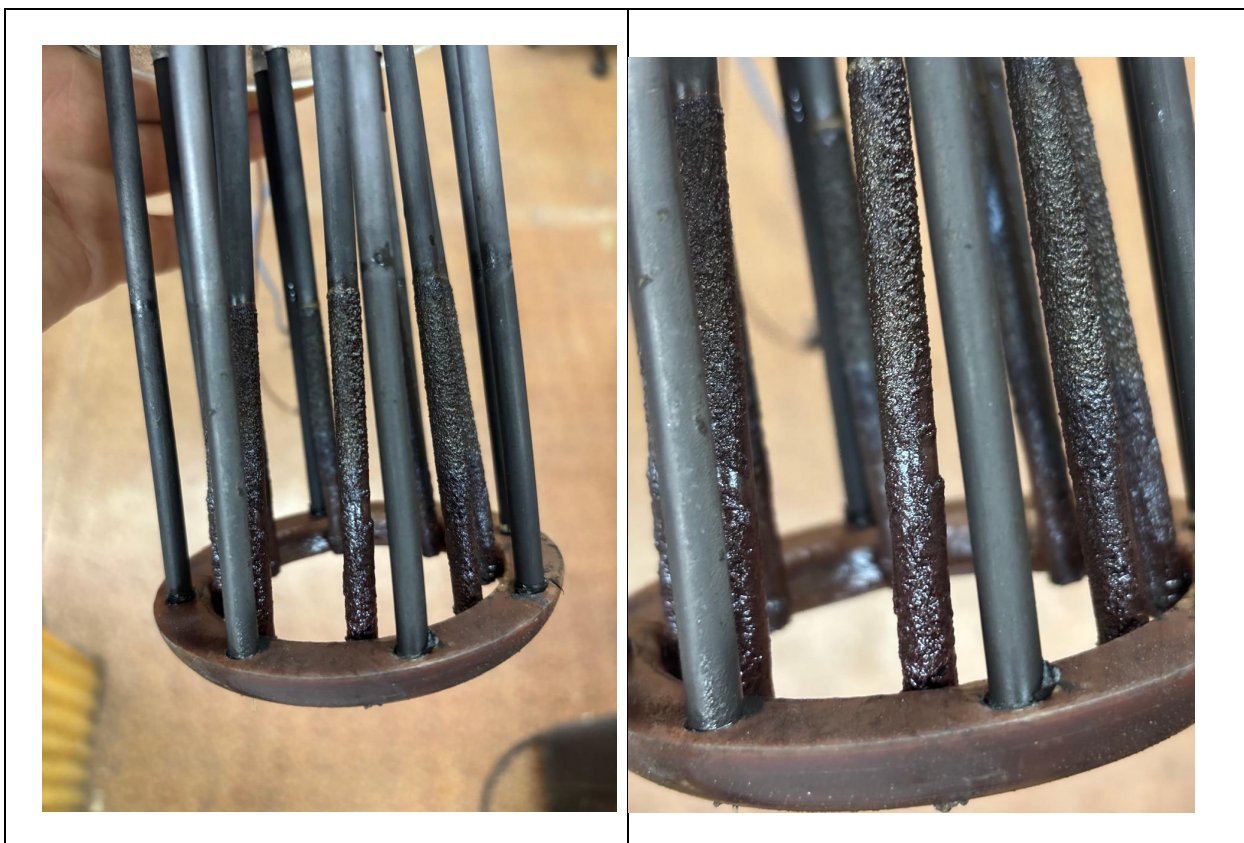
Рисунок 3.9 – Вид поверхности медного катода после опыта: красновато-медный налёт
