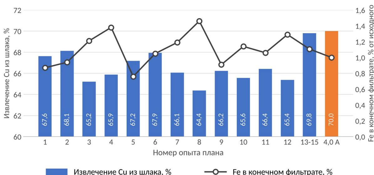
Рисунок 3.16 – Извлечение Cu из шлака и остаточное Fe в конечном фильтрате в опытах плана (13-15 – центр плана) и в контрольном опыте при 4,0 А, NaCl 175 г/дм 3 , 90 мин
