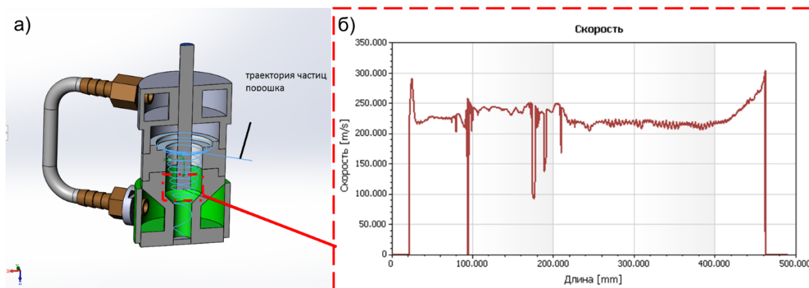
а) траектория частицы порошка; б) скорость движения частицы нитрида титана в плазмотроне
